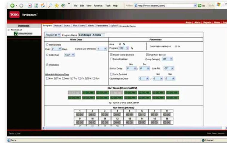
Die Online-Plattform TriComm ist besonders für die zentrale Verwaltung und Steuerung der Beregnung auf Sportanlagen geeignet. Per Smartphone, Notebook oder Tablet PC erfolgt die Steuerung via Internetzugang. TriComm arbeitet mit den Steuergeräten der neuesten Generation, z.B. TMC-424E + TDC.
